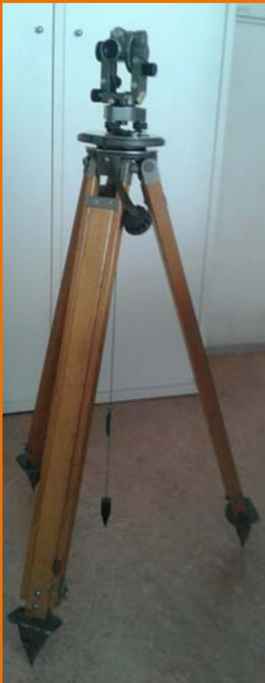
Tacheometro montato su treppiedi con filo a piombo Foto Roberta G. Arcaini (2018) APTn, ACK, sc. 69
